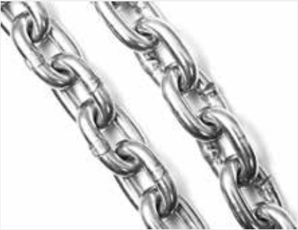
圆环链 CIRCULAR CHAIN 材质 Material: 304、316 规格 Size: \phi 4 — \phi 10 标准 Standard: DIN763、DIN766
